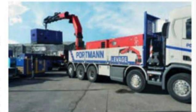
Le groupe Portmann a choisi une grue PK92.002 SH version F de Palfinger pour équiper son nouveau porteur Scania XT R580 V8 10x4\*6. Cette grue Palfinger dispose d'une portée de 18 mètres avec une capacité de levage de 3 750 kg. Elle est dotée d'un Fly jib PJ170 E qui augmente sa portée jusqu'à plus de 30 mètres. Ce bras hydraulique repliable supplémentaire peut se relever de 25° au-dessus du prolongement
