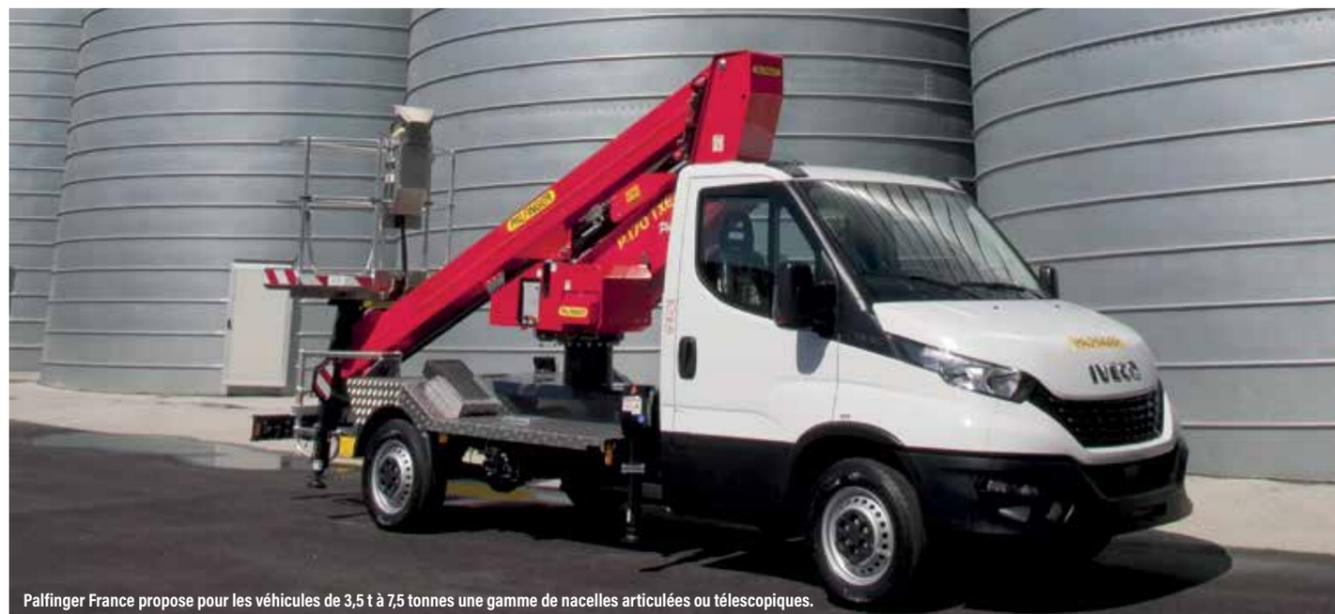
Palfinger France propose pour les véhicules de 3,5 t à 7,5 tonnes une gamme de nacelles articulées ou télescopiques.
