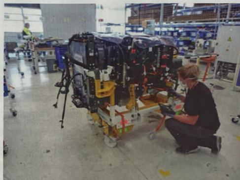
Le pack d'électronique de puissance et son radiateur prennent la place du moteur.
