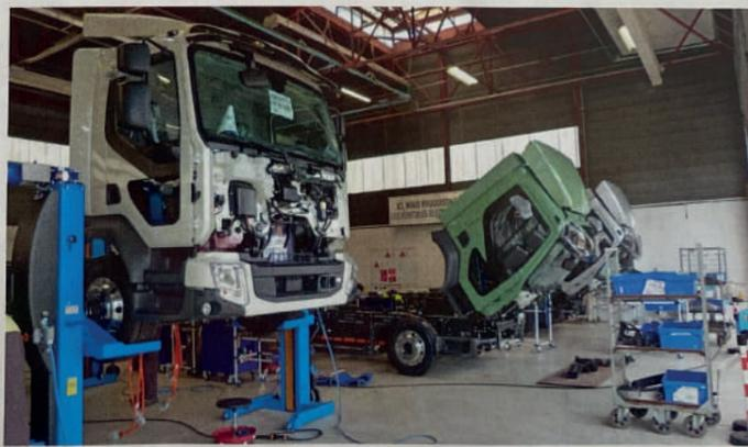
Après avoir été assemblés sur la ligne de montage, les camions reçoivent leurs batteries, leur électronique de puissance et leurs moteurs électriques.
