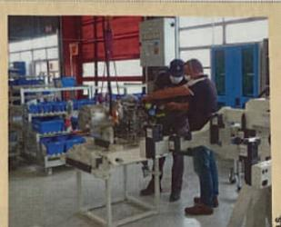
Les sous-ensembles, notamment l'accouplement du moteur à sa transmission, sont préparés dans le bâtiment X.
