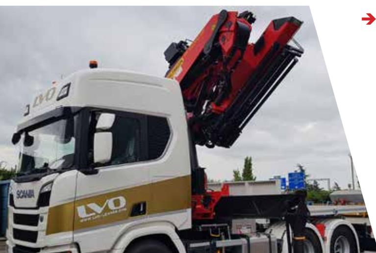
→ Fly-jib à 6 extensions : bras hydraulique supplémentaire repliable. Il augmente la portée de la grue de 12.70m et se relève de 25° au dessus du prolongement du 2ème bras.
