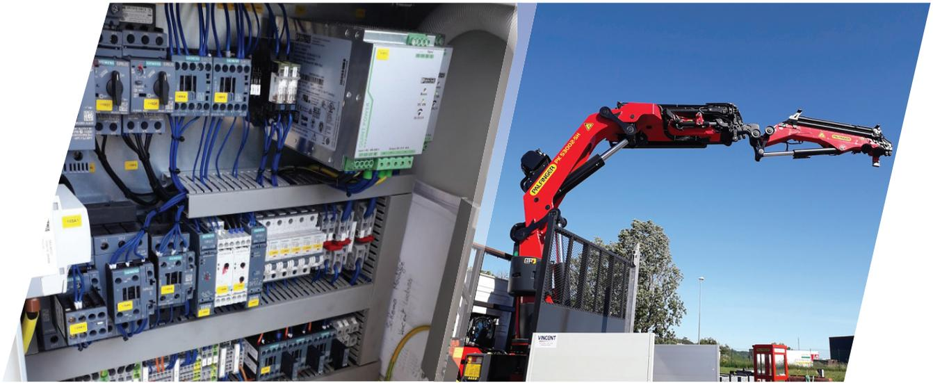
Cette grue est équipée de nombreuses technologies d'assistance pour plus de sécurité et de confort d'utilisation telles que RTC, SRC, HPSC Load, P-Fold...elle est alimentée soit par le moteur du porteur, soit par une alimentation électrique externe. Branchement sur 380V moto et armoire électrique 30KW.
