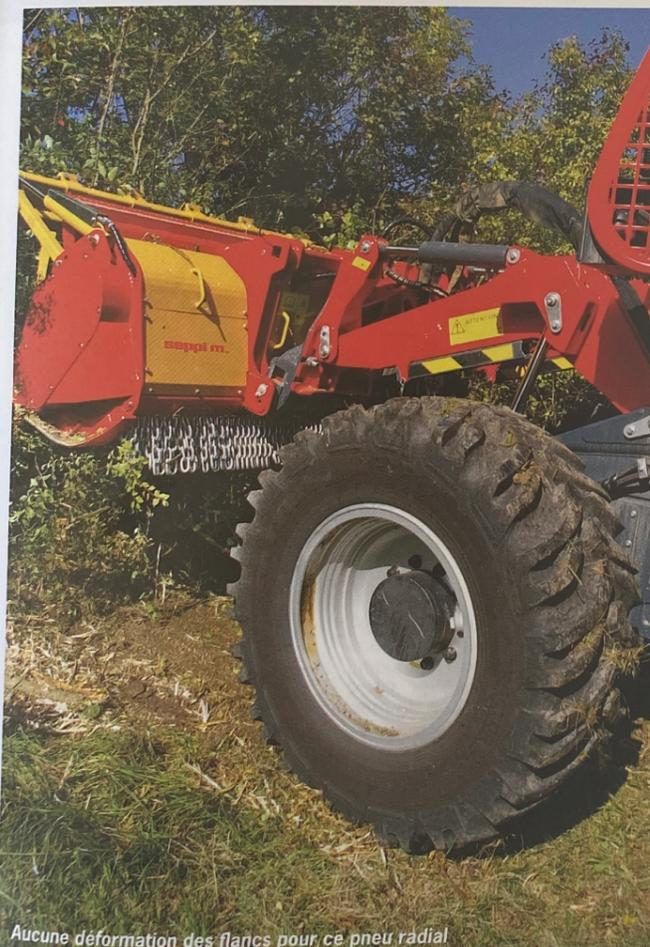
Aucune déformation des flancs pour ce pneu radial
